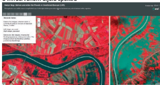
Slika 4: Swipe alat za vizualnu detekciju promjene nad snimcima u infracrvenom dijelu spektra
